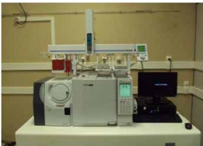
Figura 4. Cromatógrafo gasoso Shimadzu CG2010, acoplado ao espectrômetro de massas também da Shimadzu modelo MASS QP2010 Plus, injetor automático AOC5000, pertencente à Central Analítica do Departamento de Química da UFJF - MG.
