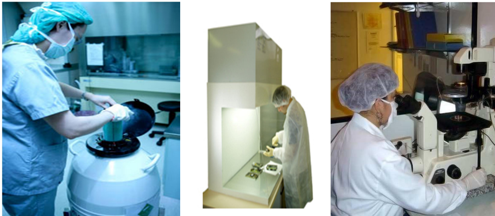
Figura 2- Contêiner para nitrogênio líquido, à esquerda (Foto cedidas pela clínica fértil), Câmara de fluxo ao centro, microscópio invertido à direita, maquinários adequados para o uso em laboratórios de micromanipulação e criopreservação (reprodução humana)
